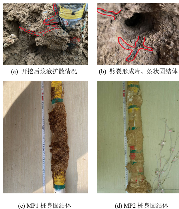
图3 黏土模型桩开挖结果实拍图
